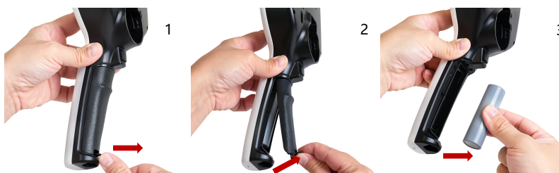
【Figure 15: Battery Removal】
